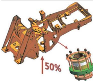
Соединение передней и задней рамы при помощи втулки ограничивает осевое движение и увеличивает износоустойчивость соединения на 50%.
