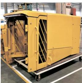
Боковое открытие капота с максимальным углом открытия обеспечивает удобство доступа для технического обслуживания погрузчика. Двухслойный радиатор увеличивает производительность системы охлаждения. Машина приспособлена для эксплуатации в экстремальных условиях и позволяет работать при температурах до 50°C. Опциональный двигатель DCEC имеет радиатор с функцией реверса, что облегчает обслуживание.
