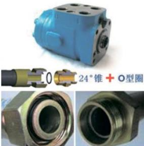
Полностью гидравлическое рулевое управление, чувствительное к гидростатической нагрузке обеспечивает плавное и точное руление; Гидравлическая система с объединением потоков от 2-х насосов обеспечивает энергосбережение и высокую эффективность; Конструкция соединений шлангов и использование уплотнительных колец минимизирует возможность протечек. Эргономичный дизайн органов управления снижает усталость оператора при длительной работе.
