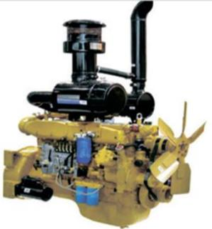
В стандартной спецификации погрузчик оснащается мощным, надежным и экономичным двигателем WEICHAI-STEYR. Двигатели SHANGCHAI SC11CB220G2B1 и DONGFENG CUMMINS 6СТА8.3-C215 можно установить опционально.
