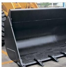
Режущая кромка ковша выполнена из особо прочного сплава и обладает хорошей износостойкостью. Использование навесного оборудования исключительно от известных китайских производителей позволяет добиться наилучшей производительности.
