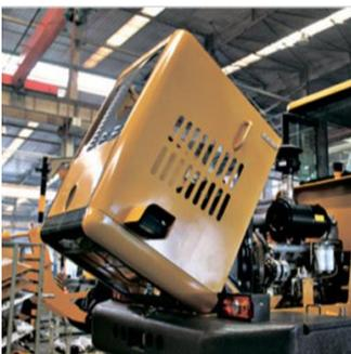
Капот двигателя новой конструкции откидывается целиком назад, что обеспечивает удобный доступ для быстрого и простого обслуживания или чистки.
