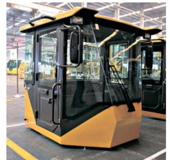
Модифицированная система отопления и кондиционирования воздуха обеспечивает комфортные условия для оператора, как в жаркое, так и в холодное время года. Пространство внутри кабины было увеличено за счет вынесения испарителя системы кондиционирования наружу.
